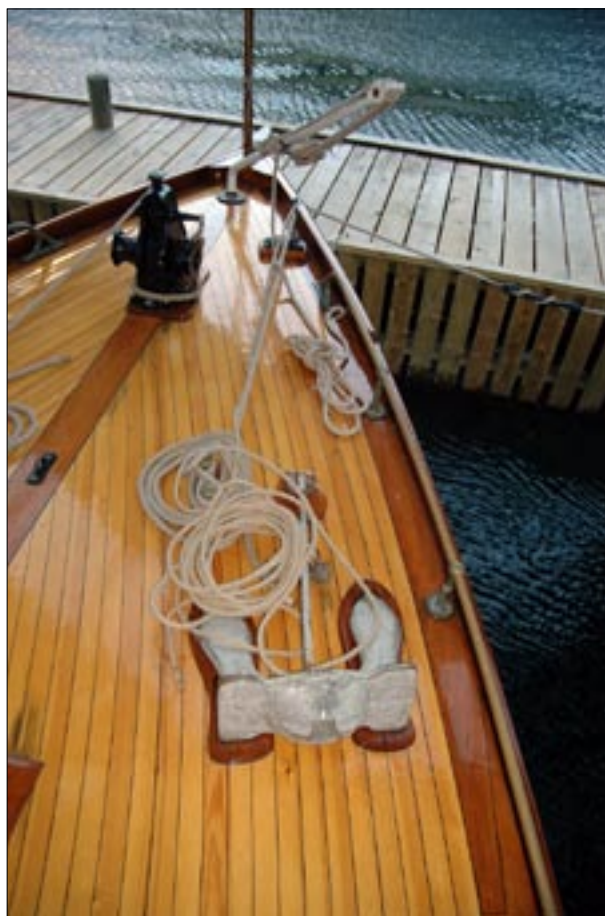
Ankerutrustning med kran og vinsj.
