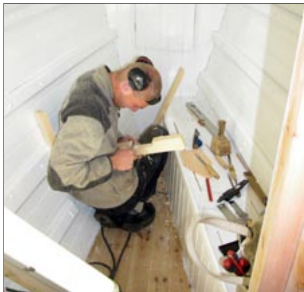
Forpiggen i mannskapslugaren er malt med hvit linoljemaling og bordet i forpiggen blir laget.
