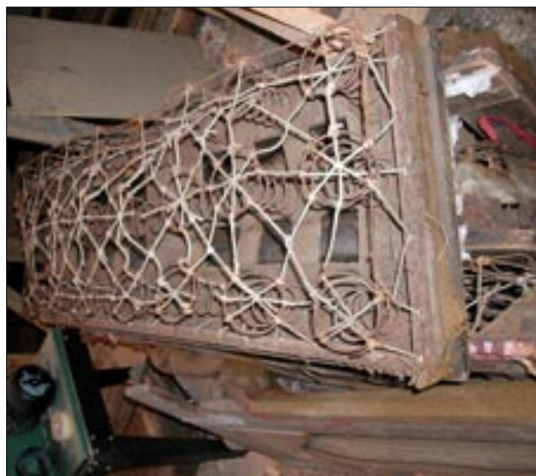
Et gammelt sete. Vi ser fjørene som sitter oppå kryssede gjorder. Over er fjørene bundet sammen med snor for å holde dem i posisjon. Oppå fjørene har det vært en "pute" på c. 60 mm i strie fylt med sjøgras (sees ikke på bildet).
