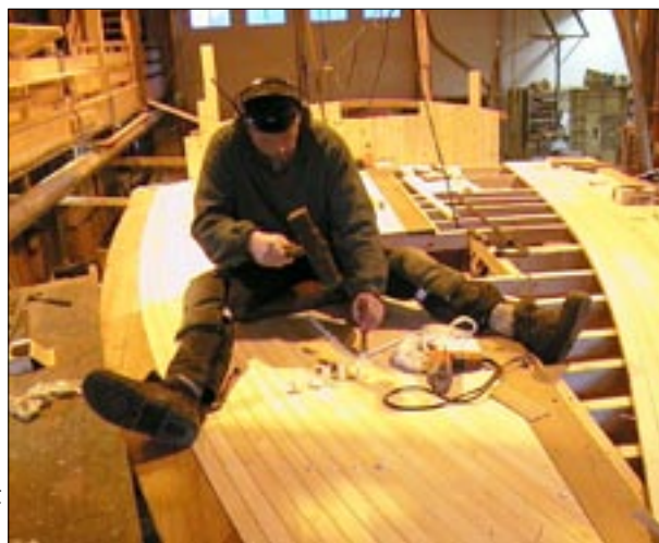
Fordekket er delvis lagt og den ene siden drives.
