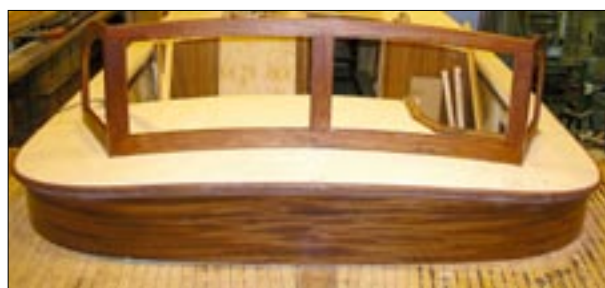
Mahognifronten er kommet på. Vindskjermen er montert.
